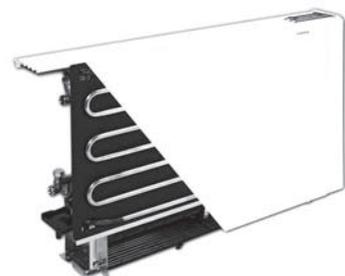
**Gruppo ventilante** comprendente ventilatore tangenziale in materiale sintetico ad alette sfalsate (elevata silenziosità) montato su supporti antivibranti in EPDM. Rotore bilanciato staticamente e dinamicamente, calettato direttamente sull'albero motore.
