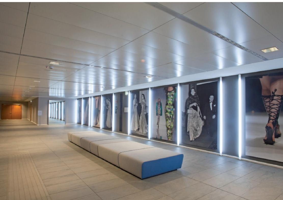
Vivacizzato da immagini a tema, il guardaroba è climatizzato con ventilconvettori a quattro tubi e aria primaria a portata costante, con griglie di areazione integrate nei controsoffitti (Pietro Paolini, TerraProject).
